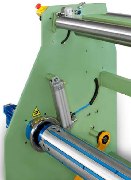
Controllo tensione di avvolgimento con cella di carico e rullo pressore
